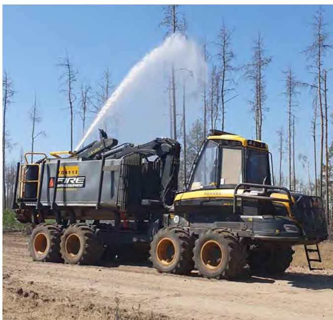
▲ Löschbox auf geländegängigem Rückezug - modernes Löschgerät in schwer zugänglichem Gebiet.
