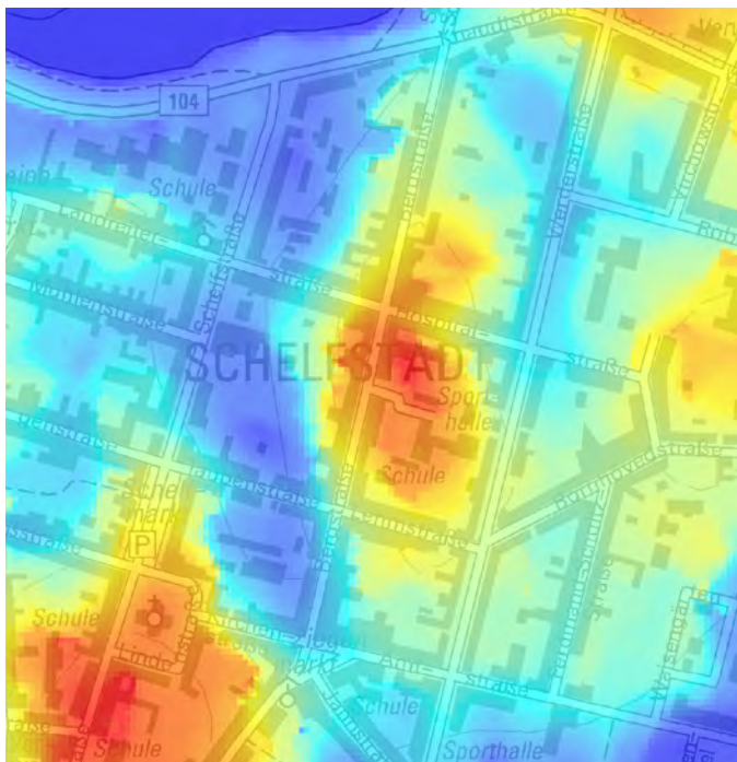
▲ Ausschnitt einer Relieffassifikationskarte nach dem topographischen Klassifikationsindex für Flachland am Beispiel Schwerin. Blaue Farben kennzeichnen Senken, an die bei Starkregen erhöhte Anforderungen an die Entwässerung gestellt werden. Quelle: LUNG.
