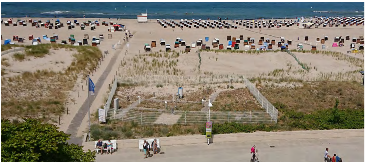
▲ Messfeld der Wetterstation Warnemünde. Hier werden unter anderem Luft- und bodennahe Temperaturen sowie Niederschlag, Wind und der Bedeckungsgrad des Himmels gemessen.
