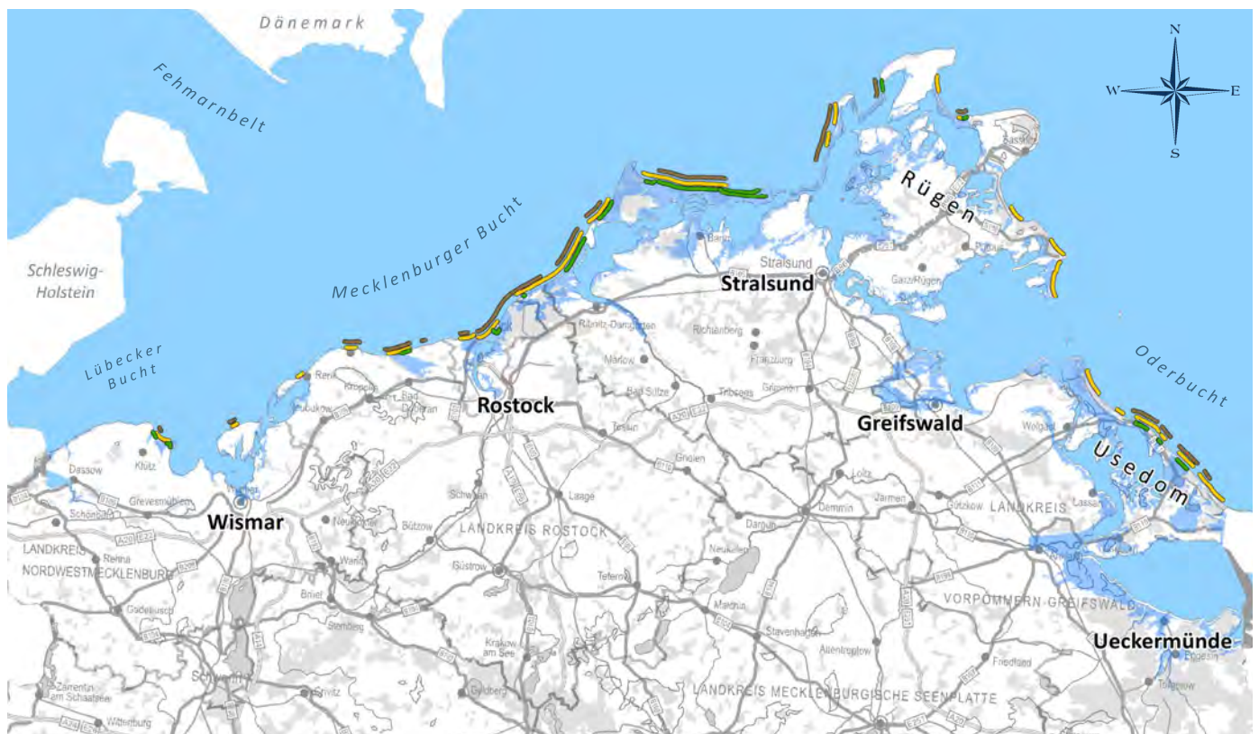
▲ Aktueller Bestand an Küstenschutzanlagen in Mecklenburg-Vorpommern, gelb: 102 km Landesküstenschutzdünen, grün: 54 km Seedeiche, grau: 75 km Bunnensysteme, (Quelle: StALUMM, Abt. Küste).
