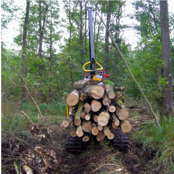
Abb. 23: Geringe Bodenbeeinträchtigung bei trockener Witterung nach zweimaliger Harvester- und siebenmaliger Kleinforwarderüberfahrung (beladen: ca. 10 t Gesamtgewicht).
