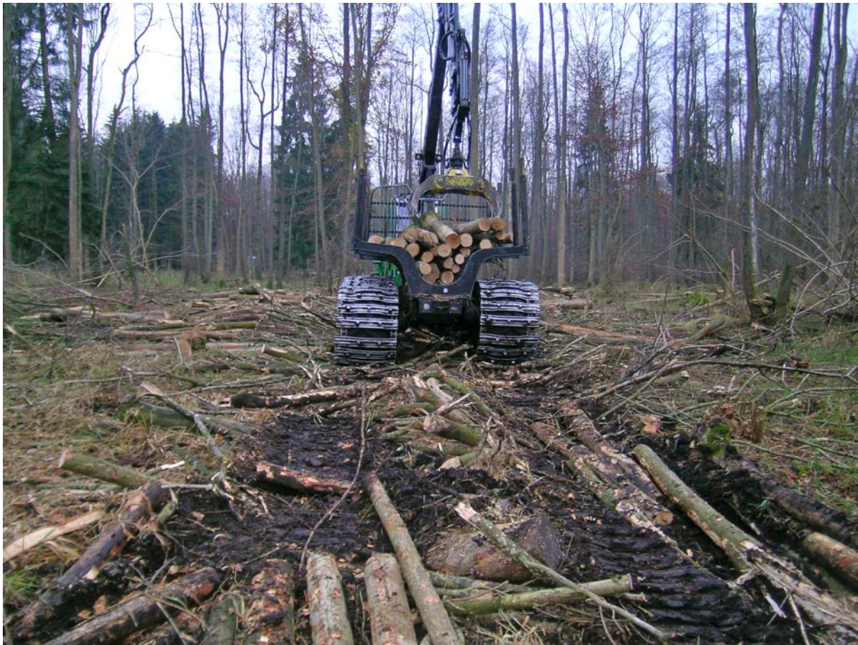
Abb. 9: Rücken der Kurzholzsortimente durch einen Forwarder mit Metallbändern auf mineralischen Nassstandorten. Kronen- und sonstiges Restholz in den Fahrspuren soll unvertretbare Eintiefungen verhindern.
