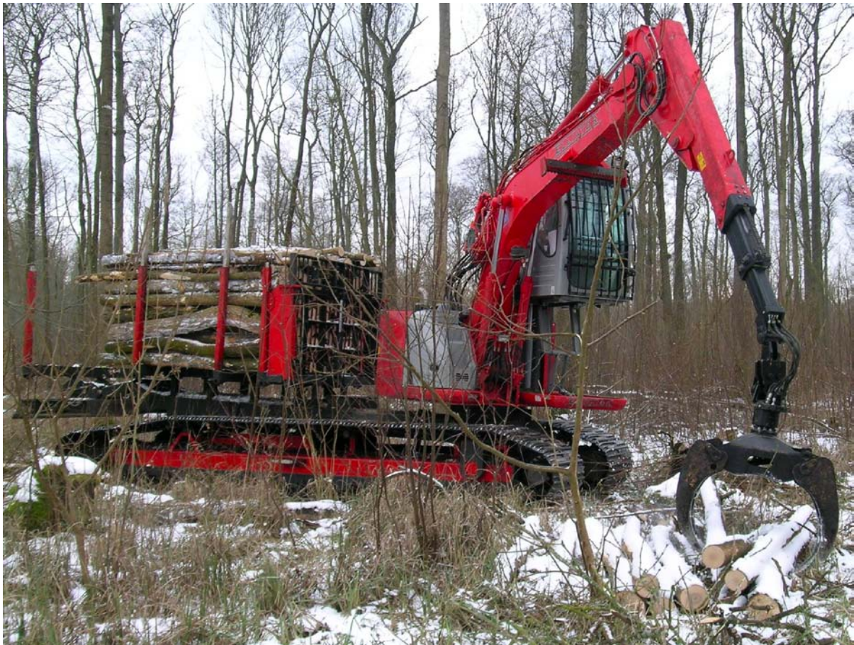
Abb. 12: Rücken von Eschen-Industrieholz durch einen Raupenforwarder vom Typ Elliator (Prototyp) auf mineralischem Nassstandort. Die Maschine hat eine Aufstandsfläche von 15 Quadratmetern.
