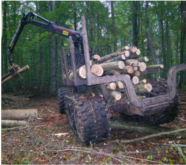
Abb. 8: Forwarder mit 710 mm breiten Stahl-Gummibändern bei der Rückung von Eschen-Industrieholz. Die vier Bänder wiegen zusammen 5,2 t.
