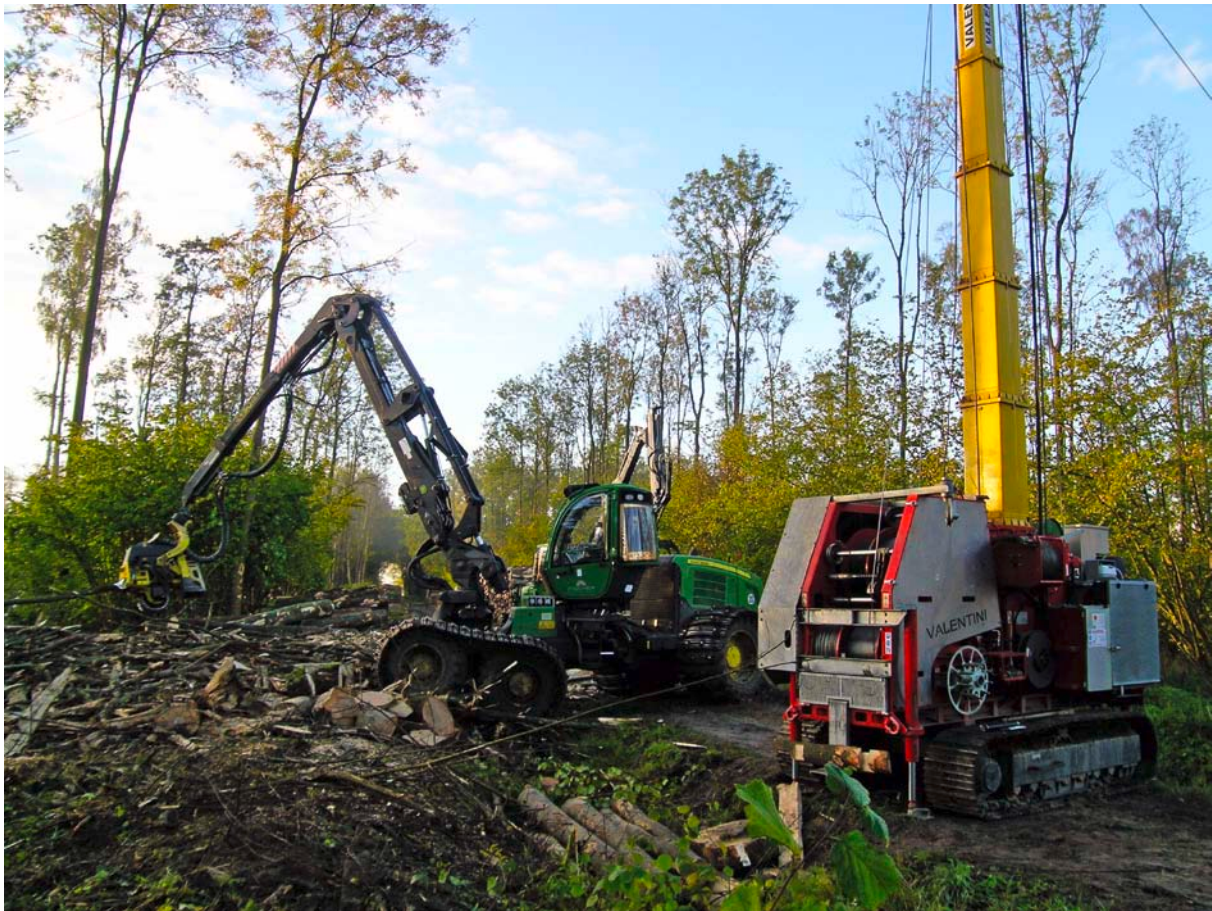
Abb. 15: Mittelstreckenseilkran Valentini V600 als Raupenversion und ein Harvester am Absenkplatz im gekoppelten Arbeitsverfahren. Es entstehen keine Zwischenpolter am Seilkran und kaum Wartezeiten für den Harvester, da die Leistungen der Maschinen sich weitgehend entsprechen.
