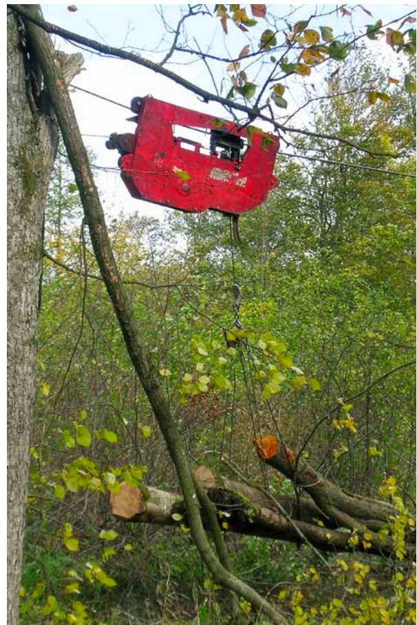
Abb. 4: Laufräder (im Vordergrund) auf einem Tragseil beim Rücken. Die Bäume werden im sogenannten Schleifrückverfahren gezogen, bei dem ein Teil des Stammes über den Boden schleift.
