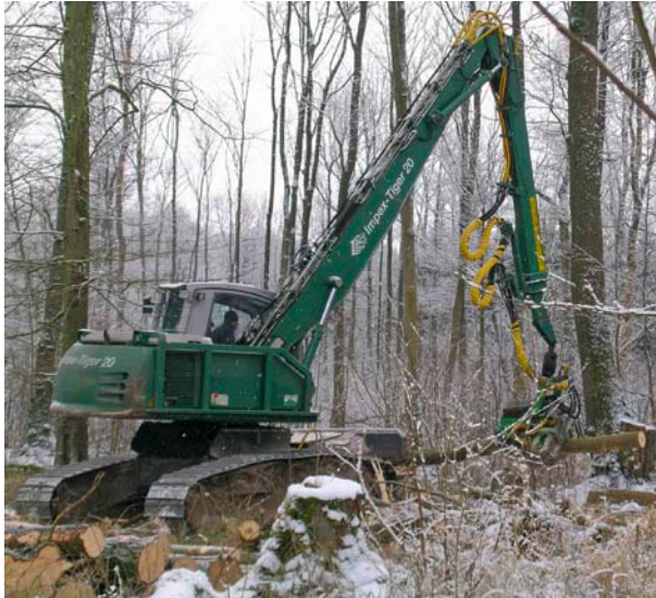
Abb. 14: Raupenharvester mit 600 mm breiten Raupenkette. Die Einstegplatten sorgen für eine gute Traktion.
