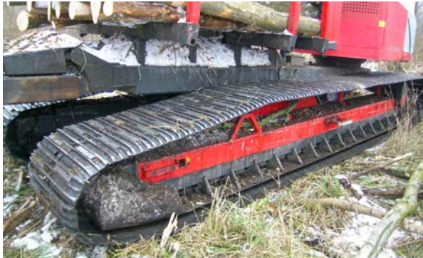
Abb. 2: Raupenfahrwerk am Raupenforwarder vom Typ Elliator.
