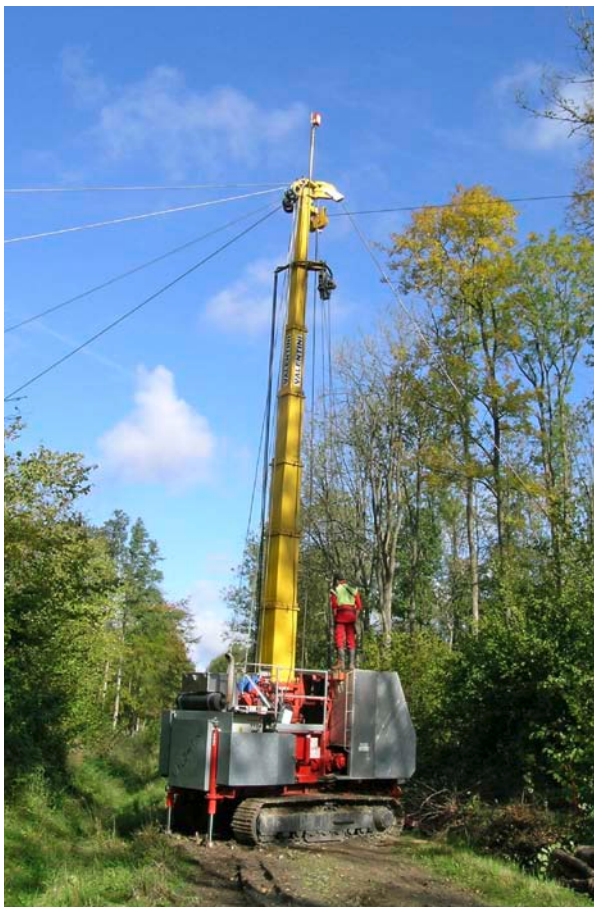
Abb. 3: Mobilseilkran vom Typ Valentini V 600 als Raupenversion.
