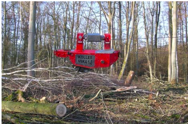
Abb. 20: Während des Beiseilens vom Hiebsort zur Trasse ist der Laufwagen durch die Tragseilklemme am Tragseil fixiert. Die Zugseilklemme ist dabei offen.
