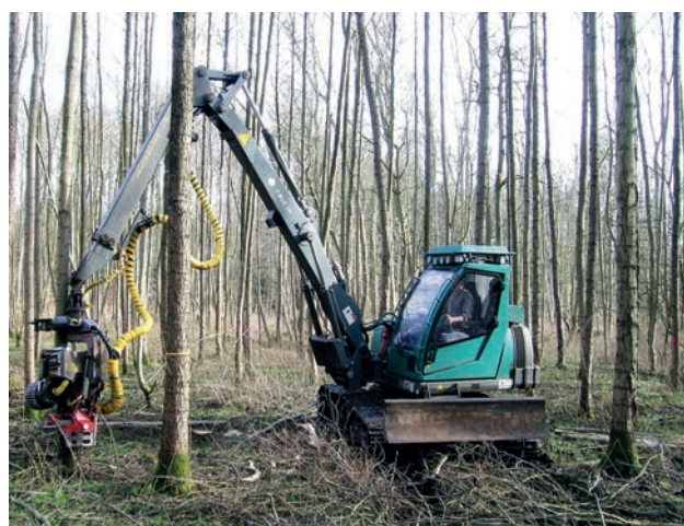
Abbildung 28: Einsatz eines mittelgroßen Raupenharvesters auf einem Nassstandort; Die Maschine wiegt rund 11 Tonnen und ist mit 600 mm breiten Ketten ausgerüstet; Foto: J. Sündermann
