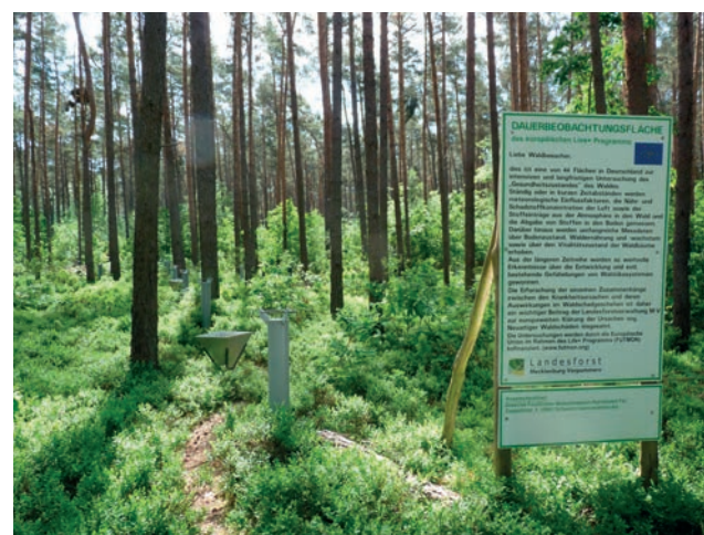
Abbildung 26: Intensivmessfläche des ursprünglichen Level-II-Programms der EU; Niederschlags- und Streufallsammler im Vordergrund Foto: J. Martin
