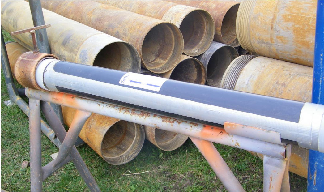
Bild 1: Vorgesägte und wiederverklebte PVC-Halbschalen für die Rammkern-Gewinnung
