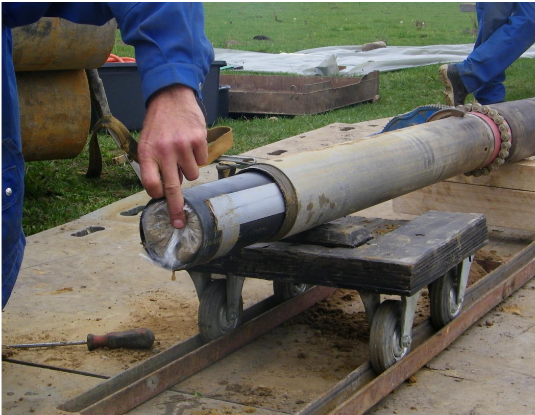
Bild 2: Vorgesägter PVC-Liner im Bohrgestänge nach erfolgtem Kerngewinn. Der nicht mit originale Sedimentmaterial gefüllte Teil des Liners wird mit inertem Material gefüllt (gefüllter PE-Beutel)
