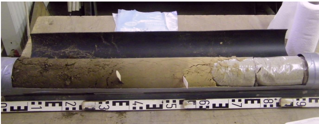
Bild 4: Optimal vorgesägt und gefüllter PVC-Liner nach Entfernen des vorgesägten und geklebten Deckels im Bohrkernlager Sternberg
