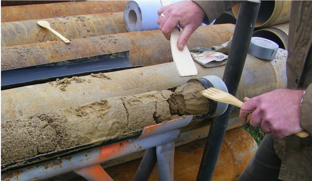
Bild 3: Feldansprache des Geologen, der die Bohrung vor Ort betreut. Probenahme mit metallfreien Gerätschaften aus Holz oder Kunststoff.
