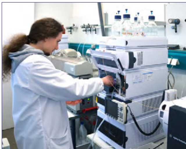
Ein LCMS wird mit Proben zur Bestimmung von PA in Honig bestückt
