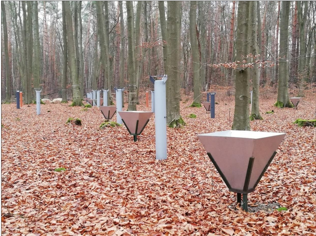
Abbildung 27: Blick in die Level II-Intensivmessfläche Sandhof im gleichnamigen Forstamt. Zu sehen ist der Schenkel eines hier installierten Messkreuzes mit Streufallsammlern und Auffangbehältern zur Analyse der flüssigen Deposition (Foto: U. Gehlhar)
