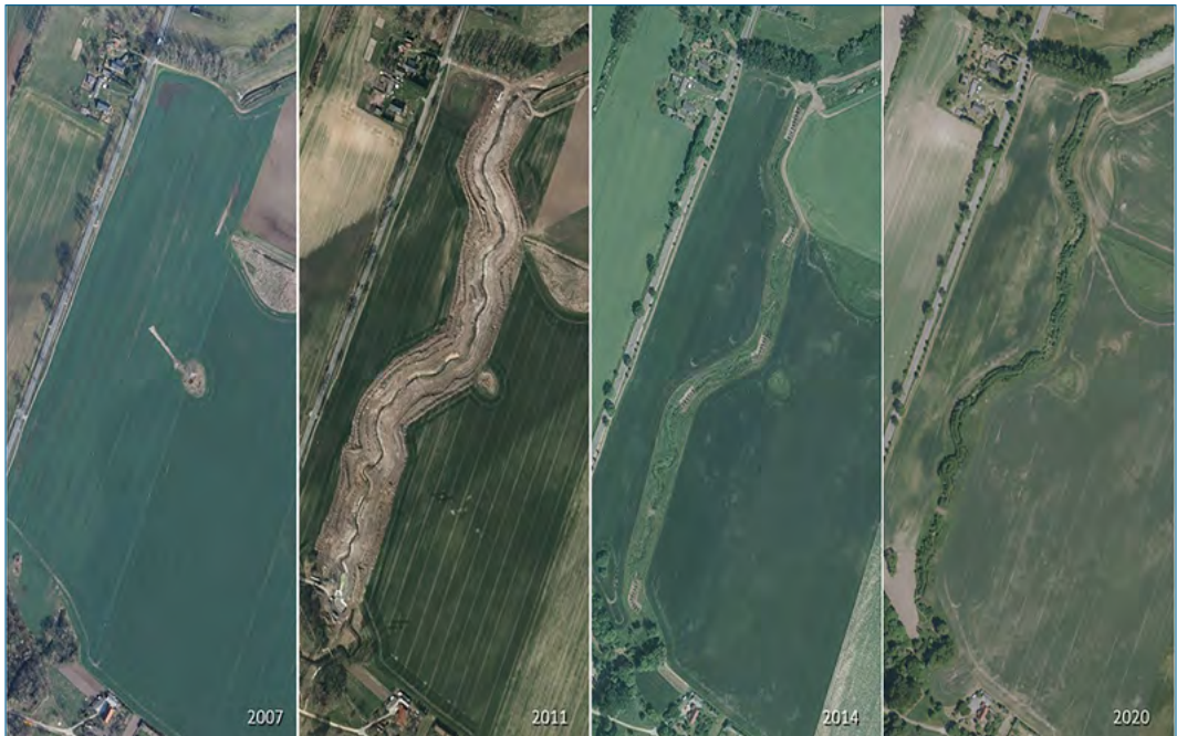
Entwicklung des Golmer Mühlbachs zwischen Golm und Schönbeck; 2007: verrohrtes Gewässer, 2011: Entrohrung und naturnahe Gestaltung, 2014 & 2020: Entwicklung der Gehölze (Luftbilder: © GeoBasis-DE/M-V)
