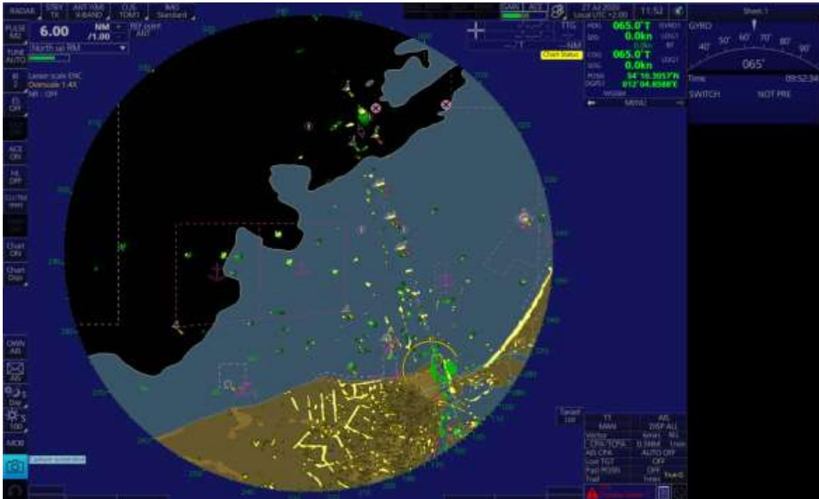
Abb. 18: Radarbild mit ECDIS Overlay und Safety Contour 17m
