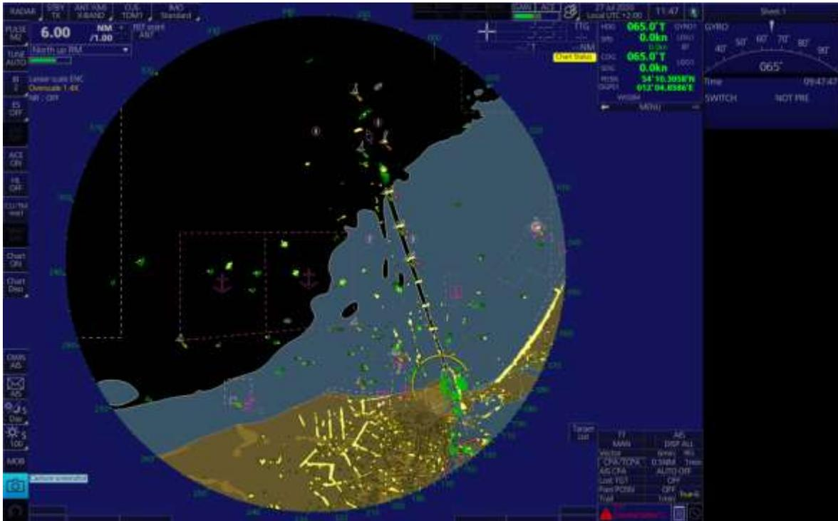
Abb. 17: Radarbild mit ECDIS Seekartenüberlagerung und Safety Contour 14m
