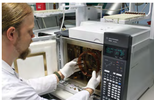
Einbau der chromatographischen Trennsäule in den Gaschromatographen, zur Bestimmung von Benzol
