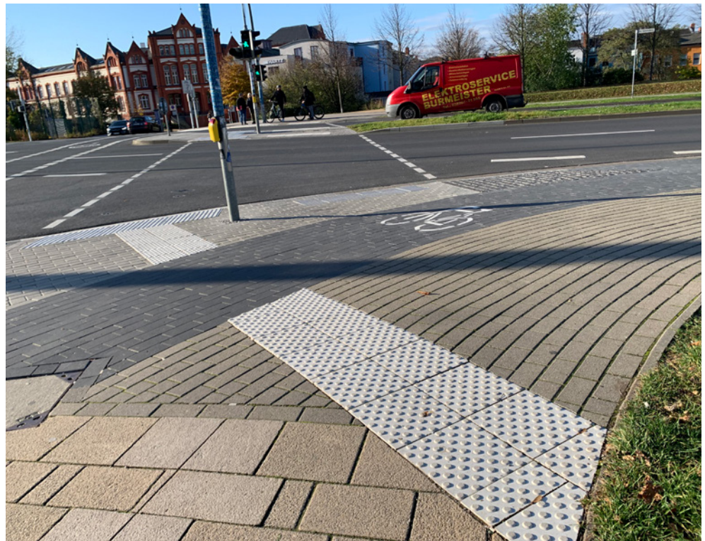
Abb. V 5 – gesicherte getrennte Querung mit Mittelinsel (LSA)
