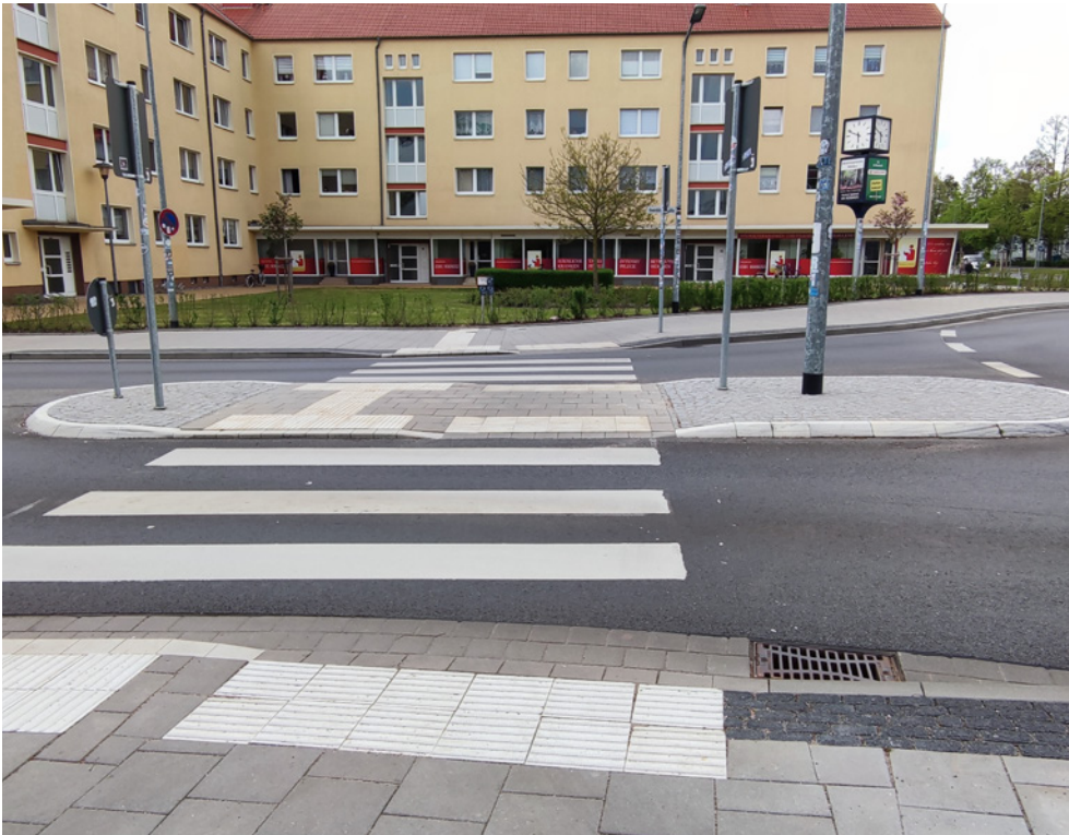
Abb. V 6 – gesicherte getrennte Querung mit Mittelinsel (FGÜ)
