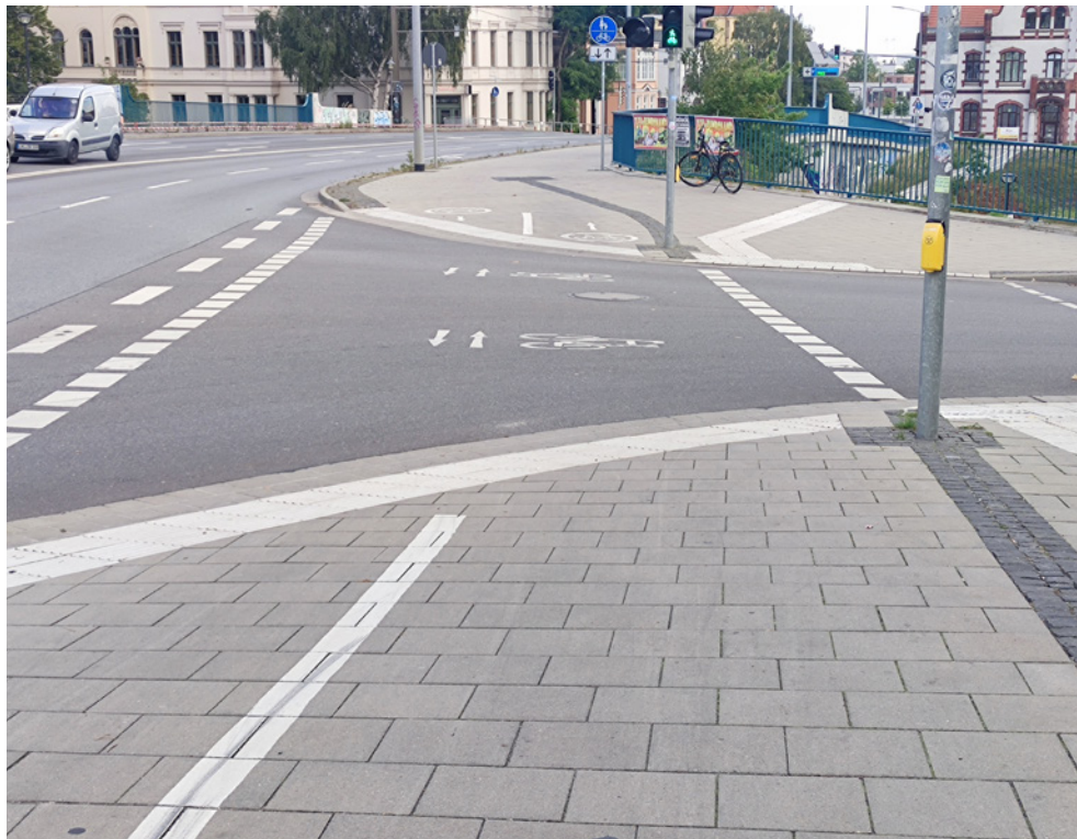
Abb. V 22 – gesicherte getrennte Querung mit zusätzlich je Fahrtrichtung getrennter Radfahrerfurt; Weiterführung auf Bauwerk als gemeinsamer Geh-/ Radweg
