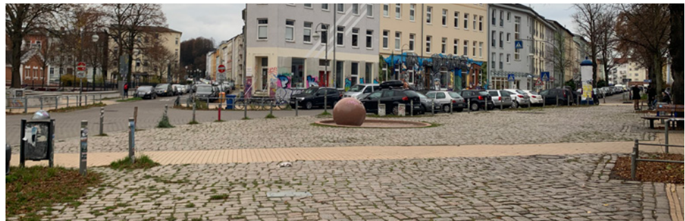
Abb. III 4 – Beispiel für Flächenquerung durch farblich und taktil kontrastierenden Gehweg
