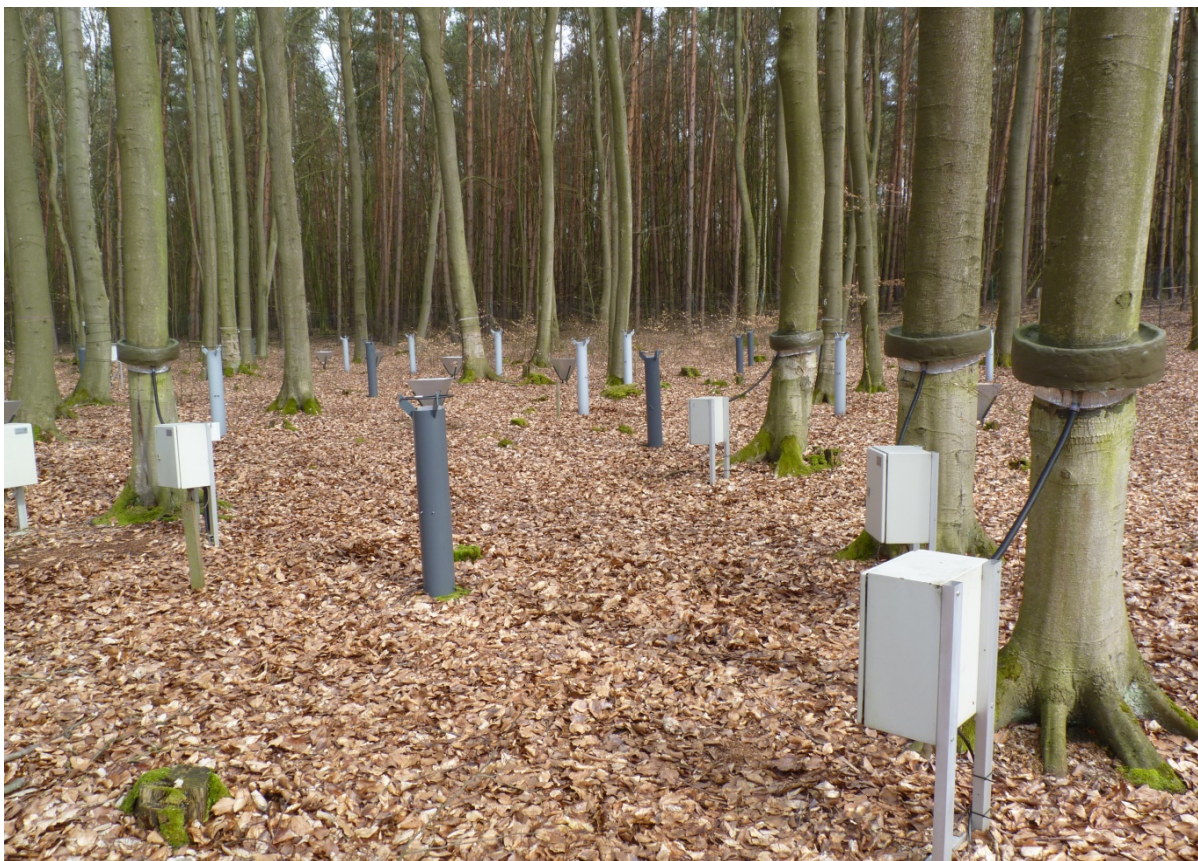
Abb. 37: Versuchsfläche Sandhof mit Depositions- und Streufallbehälter sowie Stammabflussmesseinrichtungen (Foto: Landesforstanstalt MV).
