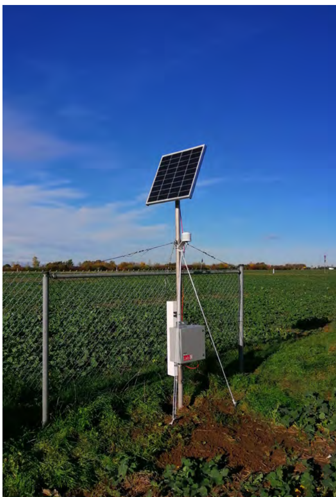
▲ Messgerät zur Bestimmung der Bodenfeuchte unter Nutzung solar emittierter Neutronen (CRNS - Cosmic-Ray Neutron Sensing).
