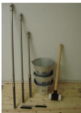
A35 | Links: Pürckhauer- Bohrstock zur Entnahme von Bodenproben, rechts: Probeentnahme mit Spatenaushub. (Fotos: Dr. Kape)
