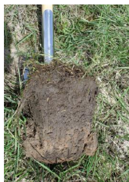
A35 | Links: Pürckhauer- Bohrstock zur Entnahme von Bodenproben, rechts: Probeentnahme mit Spatenaushub. (Fotos: Dr. Kape)
