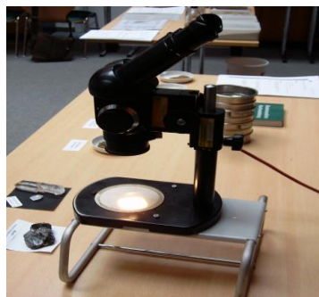
A32 I Mit Hilfe des Binokulars (mit beiden Augen) kann der Boden betrachtet und analysiert werden. (Foto: A. Niegengerd)
